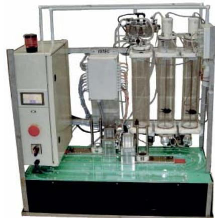
Automatische Filtrationseinheit, um Algen für die Bestimmung im Biosensor aufzubereiten (Foto: ISITEC)
