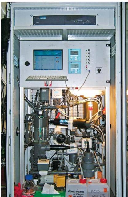
Blick ins Innere einer FerryBox: Kontrolleinheiten und Messinstrumente (Foto: HZG)
