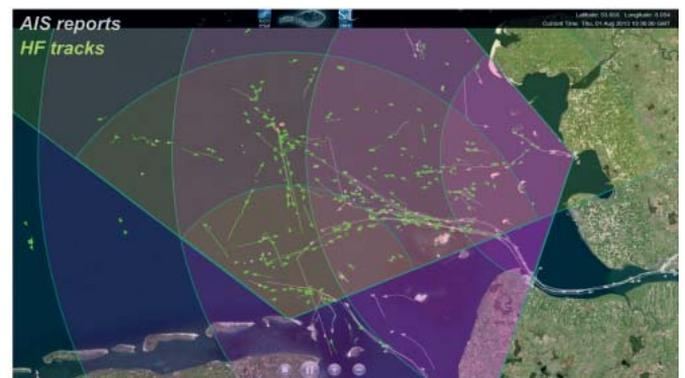
Beispiel von Schiffstracking mittels HF-Radardaten (Daten vom 1. August 2013, 30-Minuten-Intervalle). Diese Ergebnisse können andere Datenquellen, wie das AIS, ergänzen.
